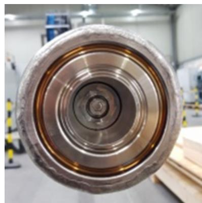
Baixo volume morto interno da sonda reduz o tempo de resposta, assim como a necessidade de purgas constantes, aumentando a disponibilidade de coleta dos gases do processo (24/7).
